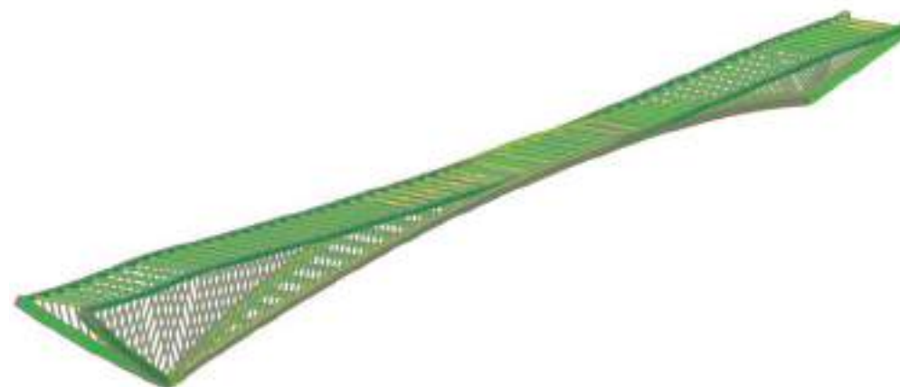
Pėsčiųjų tilto įtempių pasiskirstymas nuo skaičiuotinių apkrovų
